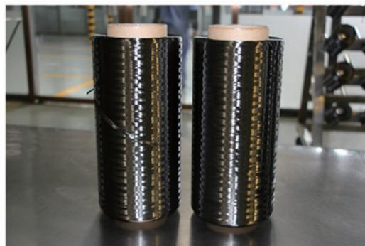
项目以缺陷控制为核心，在“聚合—纺丝—碳化”全流程展开关键技术和工程化技术研究，进一步减少纤维缺陷，提升碳纤维性能。创新开发了原液制备技术，实现了超高强度碳纤维用高分子量、高特性粘度、高均一性的聚合原液稳定连续生产；攻克了超高强度碳纤维原丝干喷湿纺关键技术，实现了 T1000G 级超高强度碳纤维原丝的稳定制备；突破了预氧化和碳化纤维结构精细控制技术，实现了碳纤维拉伸强度  $\geq 6400\text{MPa}$ ，拉伸模量  $\geq 294\text{GPa}$ ，断裂延伸率  $\geq 2.19\%$ ，体密度  $1.79 \pm 0.02\text{g/cm}^3$ ，线密度  $450 \pm 12\text{g/km}$ 。项目获授权专利 15 项，其中发明专利 9 件、实用新型专利 6 件。
